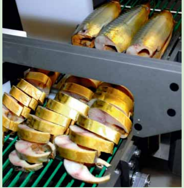
Bu makine, bütün füme uskumruları boylu boyunca eşit porsiyonlara bölmek için dikey kesim yapar.
