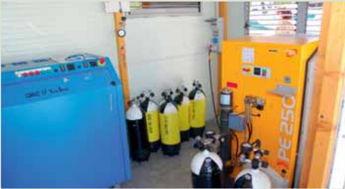
Ağların ve kafeslerin bakımı ve balıkların kontrolü için dalgıçların kullandığı hava silindirlerini doldurmak üzere kullanılan kompresörler
