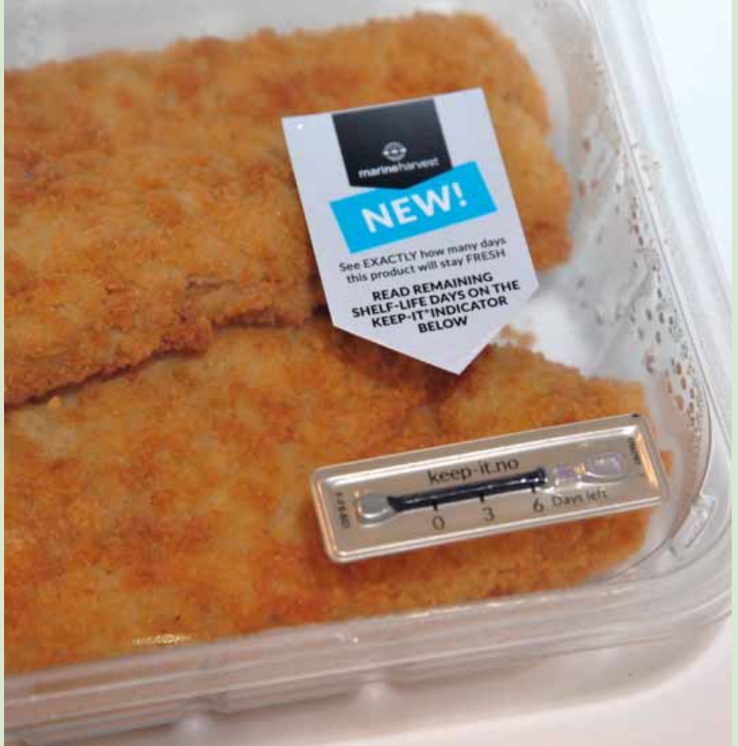
“Keep it” (“sakla”) ve “intelligent label with memory” (“hafızası olan akıllı etiket”), soğuk-zincir dahilindeki ısı dalgalanmalarını kaydeder ve ürünün kalan raf ömrünü bir çubuk halinde gösterir.
