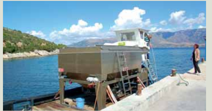
Yemin kafeslere verilmesi için gemiye monte yem aktarma makinesi kullanılır. Şirkette bu makinelerden iki tane bulunmaktadır.
