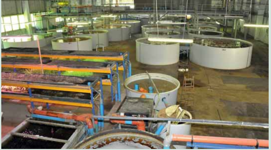
Kapalı devridaim prensibiyle çalışan kültür balıkçılığı sistemlerinde (RAS) su, karmaşık bir işlemle temizlenerek yeniden kullanıma girdiğinden, daha da etkili bir su tasarrufu sağlanır.
