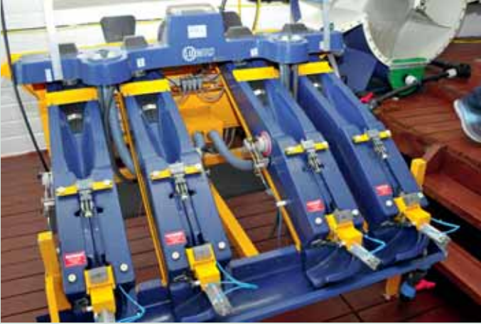
Büyük miktarlarda balığın aşılmasının gerektiği Norveç somon yetiştiricilik sektöründe, aşının enjekte edilmesi için bile otomatik sistemler kullanılıyor.
